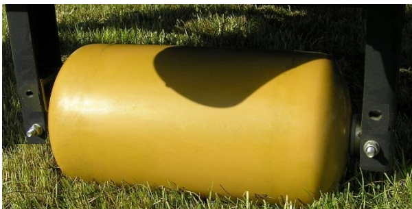
Die Schrauben halten auch die Bodenstützrolle, hier an der tiefsten Stelle montiert
