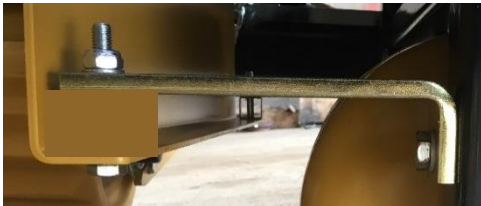
Die Schrauben halten auch die Bodenstützrolle, hier an der tiefsten Stelle montiert
