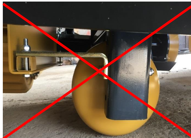
Die Schrauben halten auch die Bodenstützrolle, hier an der tiefsten Stelle montiert
